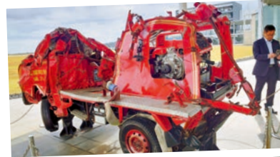
津波により変形した消防車
